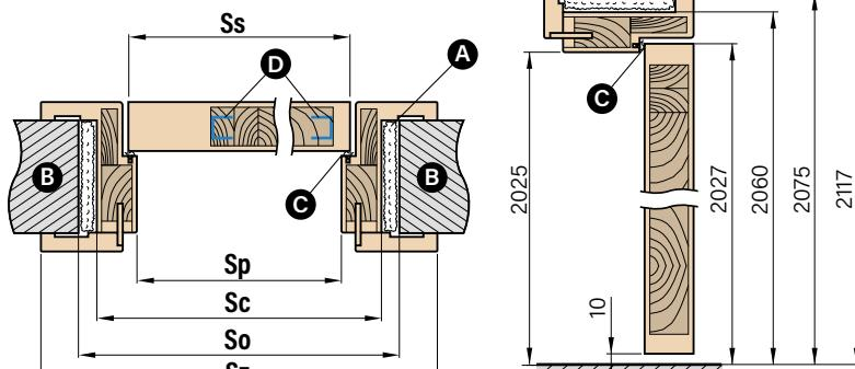
■ A- Montageschaum ■ B- Wand ■ C- Dichtung ■ D- U-Profil aus Stahl
