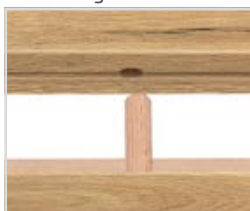
Stabile Verbindung mit Dübeln
